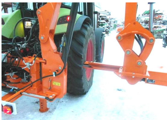
Rys. 39. Ryzyko kolizji głowicy z ciągnikiem lub ramieniem wysięgnikowym
