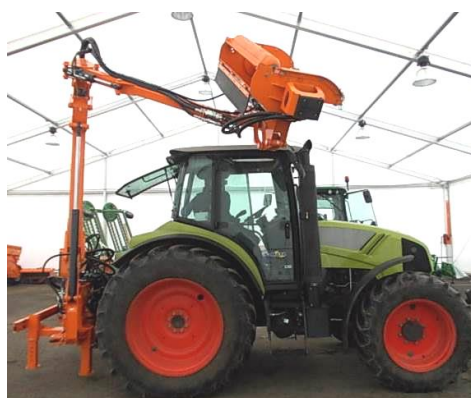
Rys. 39. Ryzyko kolizji głowicy z ciągnikiem lub ramieniem wysięgnikowym
