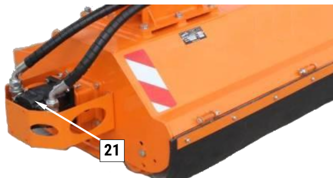
Rys. 62. Silnik hydrauliczny napędzający wał z nożami bijakowymi
