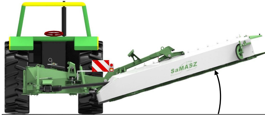
Rys. 17. Położenie kosiarki w pozycji przejazdu na uwrociach
