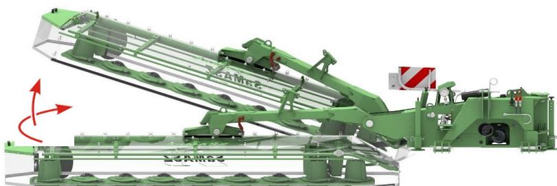
Rys. 10. Jednoczesne odchylenie kosiarki do góry oraz do tyłu po zadziałaniu bezpiecznika
