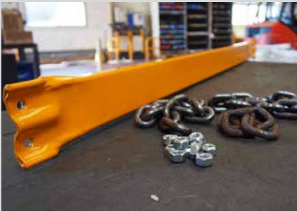
Ruchoma podłoga z szybkim mocowaniem w kształcie litery «U», przykręcanym śrubami dla ułatwienia konserwacji.
